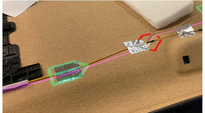
Dank Workflow Awareness wird der Montagefortschritt automatisch erkannt. Der Nutzer erhält unmittelbares Feedback über korrekte bzw. falsche Verklebungen, für 100% Vollständigkeit und Korrektheit.
