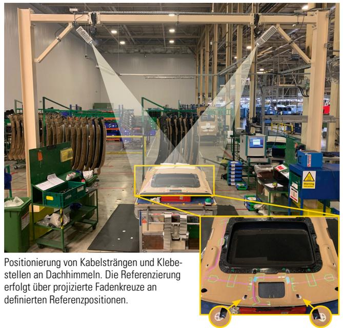
Positionierung von Kabelsträngen und Klebestellen an Dachhimmeln. Die Referenzierung erfolgt über projizierte Fadenkreuze an definierten Referenzpositionen.
