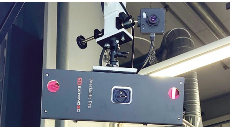
Bild 2: Eine Software steuert die Projektion und wertet Kameradaten, CAD-Daten oder Informationen anderer angeschlossener Systeme aus, Bild: EXTEND3D.
