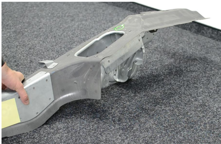
Die Projektion wird unmittelbar an dynamische Bewegungen des Bauteils angepasst.
