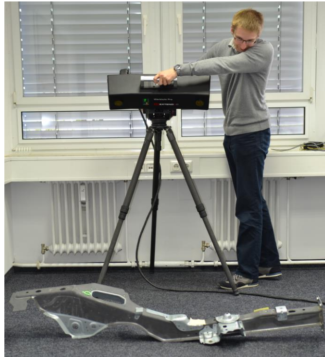
Hochgenaue, markerlose Referenzierung des Werklicht Pro Laserprojektors.
