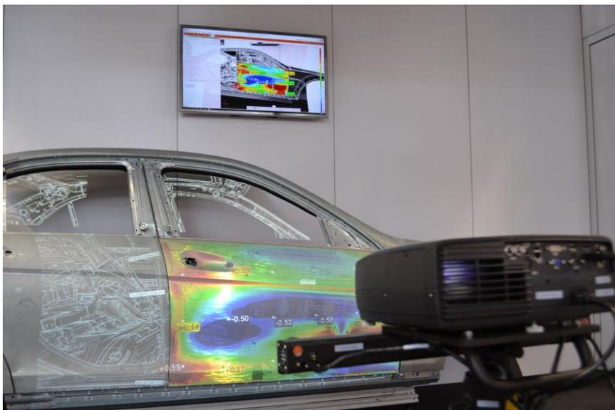
Das Verfahren zur markerlos-modellbasierten Initialisierung von Bauteilen steigert die Flexibilität beim Einsatz von WERKLICHT Pro Laserprojektoren sowie WERKLICHT Video Projektoren weiter und ermöglicht, künftig in vielen Montage- und Prüfprozessen komplett auf Marker zu verzichten.
